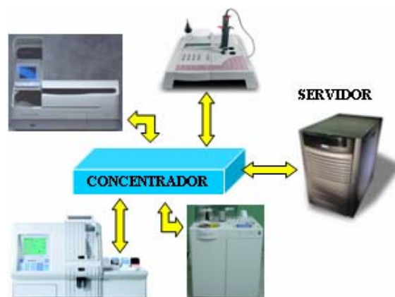
Fig. 1: Conexión de equipos de laboratorio clínico a un servidor de base de datos.
